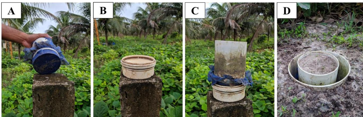
(A) Tecido para evitar a perda de solo; (B) CAP; (C) Microlisímetro e (D) Microlisímetro Instalado no Solo.
