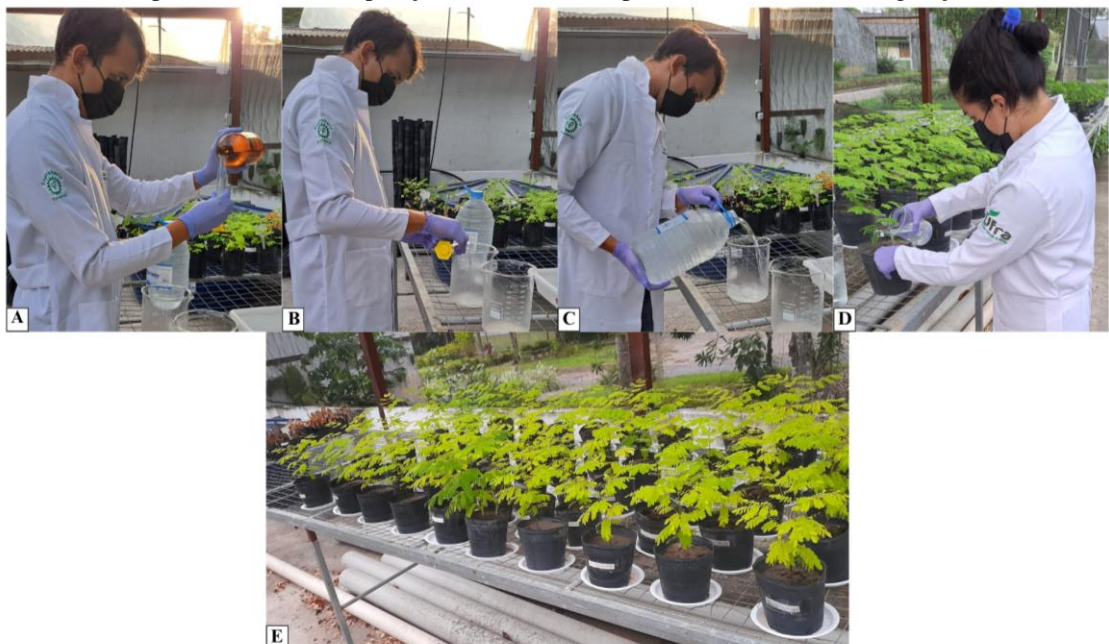
Figura 7 - [A], [B], [C]: Preparo da solução com cloreto de Cd e água deionizada; [D]: Aplicação da solução na unidade experimental; [E]: Disposição das unidades experimentais na casa de vegetação
